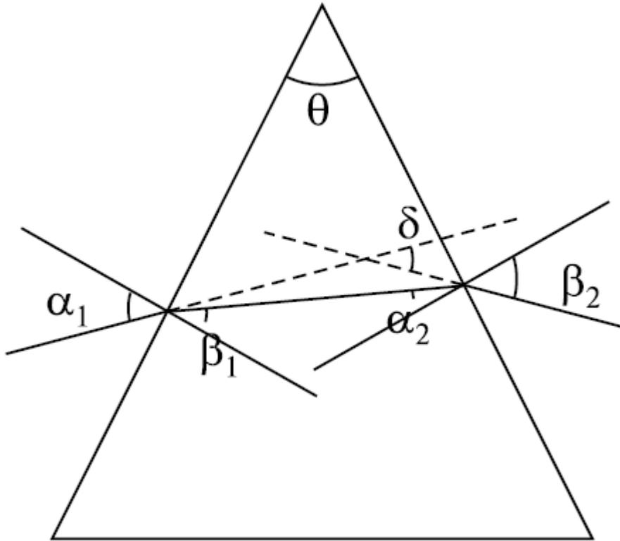
Закон преломления света позволяет рассчитать ход лучей в различных оптических устройствах, в частности, в треугольной призме. В призме световой луч дважды испытывает преломление на преломляющих гранях и изменяет свое направление.
