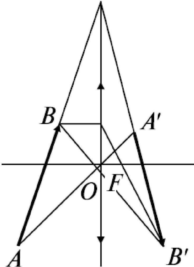
19. *Решение.* Правый фокус можно определить, проведя из точки  $B$  луч, параллельный оптической оси. После преломления в линзе этот луч пройдет через точку  $B'$ . Точка пересечения луча с главной оптической осью будет правым фокусом линзы. Аналогично определяется левый фокус.
