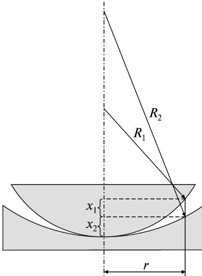
**Решение.** Определим величину  $x_1$  воздушного зазора между плосковыпуклой и вогнутой линзами на расстоянии  $r$  от точки их соприкосновения — центра линз. Из рисунка видно, что
